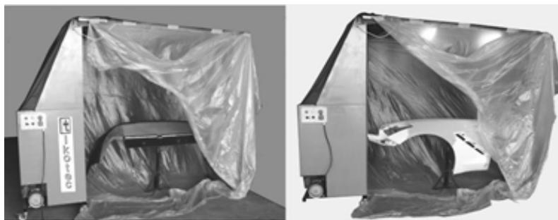
Die Schrankwand enthält den Filter von Schmutzpartikeln oder Farbe, durch die die Luft vom Ventilator angesaugt wird. Das Dach enthält 3 Filterpaneele Partikel, durch die saubere Luft heruntergeblasen wird. Wenn ein Bereich des Fahrzeugs lackiert wird, wird er seitlich in der Nähe der Kabine platziert, und ein Fenster wird perfekt an den zu lackierenden Bereich angrenzend dargestellt (Vorgang ähnlich dem üblichen Zonenlackieren in einer herkömmlichen Lackierkabine).
