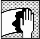
Oberflächenreinigung; Entfernen Sie vor dem Auftragen von Autosurfacer Rapid jegliche Oberflächenverunreinigung unter Verwendung entsprechender Oberflächenreiniger. *Wo Spachtel zugegen ist, Kontakt mit Wasser vermeiden (z.B. wasserbasierende Reiniger).*
