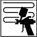
Einen mittleren geschlossenen Spritzgang auftragen. Eine Zwischenablüfzeit von 1-3 Minuten bei 20°C gewähren.
