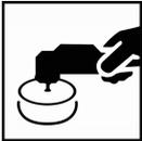
Staub und geringfügige Fehlstellen können nach Erreichen der angegebenen Lufttrocknungszeiten oder nach einer vollen Trocknung bei 60°C Objekttemperatur, gefolgt von einer Abkühlphase auf Umgebungstemperatur, auspoliert werden. Staubeinschlüsse vorsichtig ausschleifen und die Oberfläche gemäß den Polierempfehlungen wiederherstellen.
