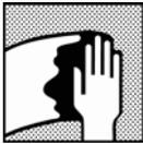
Entfernen Sie vor dem Decklackauftrag jegliche Oberflächenverunreinigung unter Verwendung entsprechender Oberflächenreiniger.
