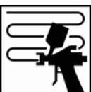
Einen mittleren geschlossenen Spritzgang auftragen. Eine Zwischenablüßzeit von 3-5 Minuten bei 20°C gewähren. Anschließend eine volle Schicht auftragen und vor der Ofentrocknung eine Ablüßzeit von 5-10 Minuten bei 20°C gewähren.
