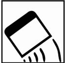
Zum Auftragen des Spachtels auf den blanken Untergrund, Spachtelmesser in einem Winkel von 60° halten. Vermeiden Sie dicke Spachtelränder im Umkreis der Reparaturstelle, indem Sie den Spachtel auslaufend zum Originallack ziehen.
