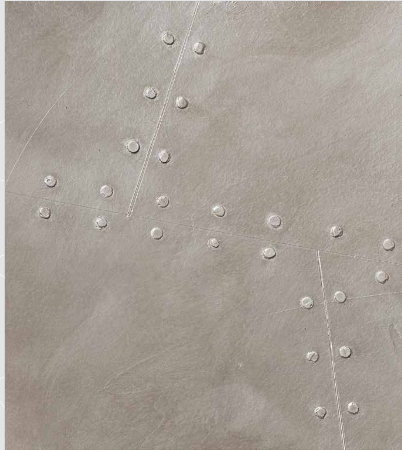
Herstellung Industrieoptik mit Texture weiß / Basis; anschließende Farbgebung mit Cyberlux Silber
